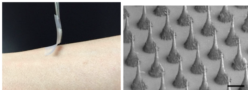
ภาพแสดงตัวอย่างแผ่นแปะอินซูลินอัจฉริยะและโครงสร้างของเข็มขนาดจิ๋วจำนวนมากบนแผ่นแปะ โดยขนาดของสเกลบาร์เท่ากับ 200 ไมครอน (6-7)
